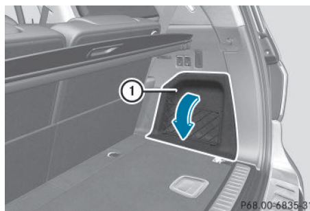
Trappe de maintenance droite
